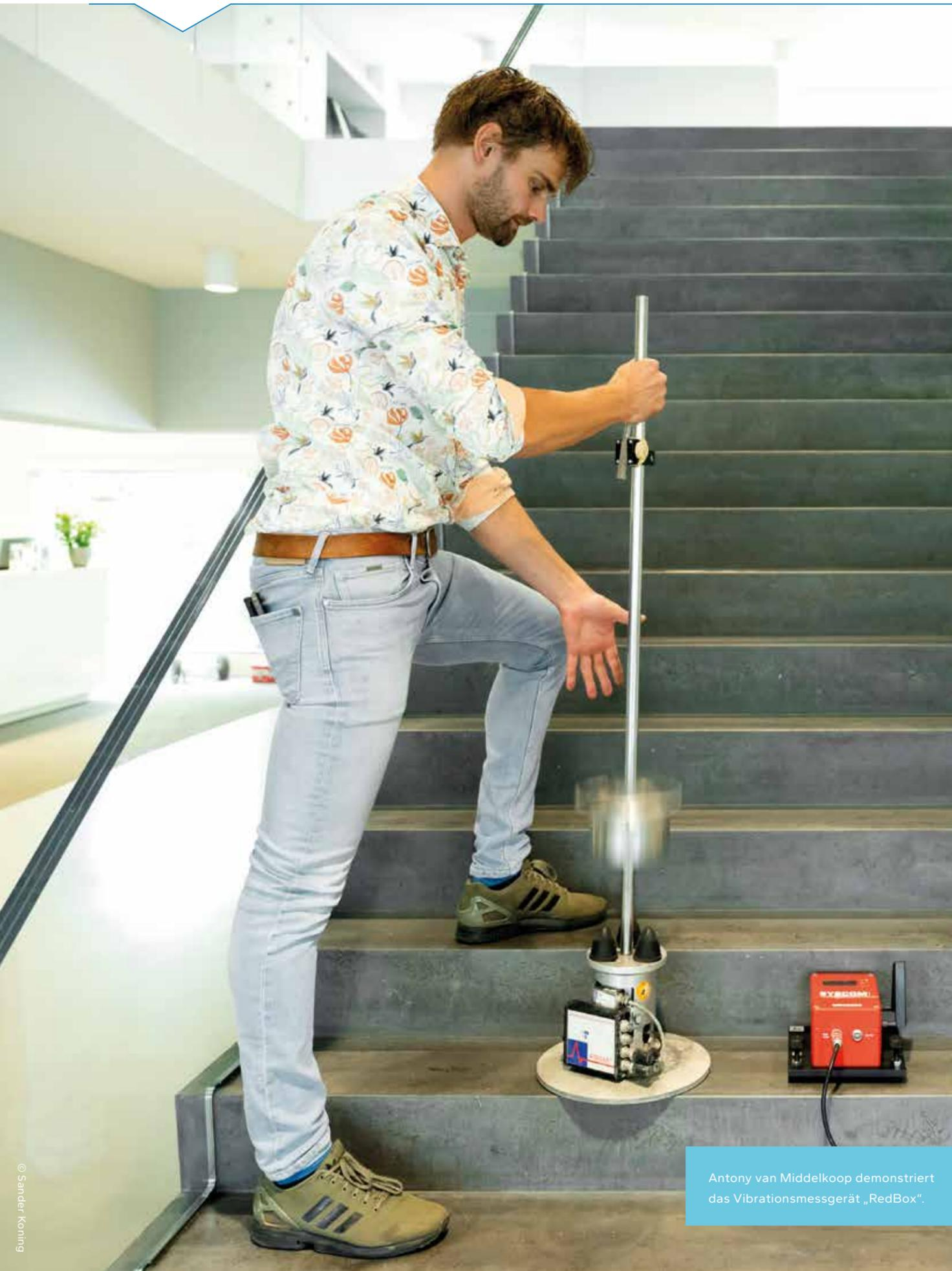
Antony van Middelkoop demonstriert das Vibrationsmessgerät „RedBox“.
